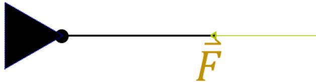
Figura 1: Uma força F sendo aplicada na barra, quando a força é paralela a direção da barra, é intuitivo que a barra não rotaciona
